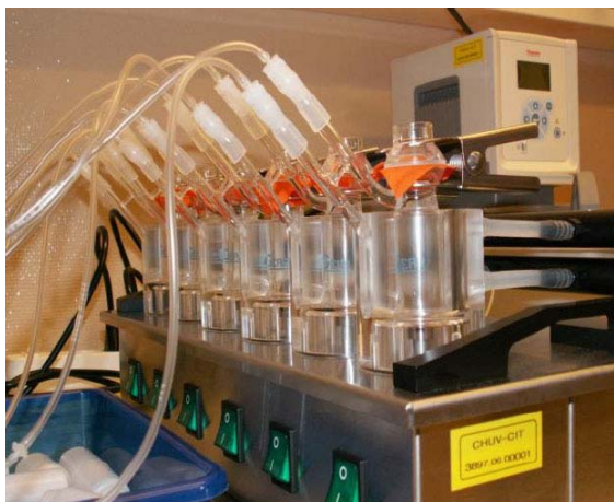
Illustration 23 : Essai de perméation (6 cellules) sur gant de protection en nitrile (Source : IST)
