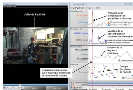
**Illustration 4 : Extrait de synchronisation de vidéo et mesures en temps réel. Une augmentation de l'exposition de l'opérateur aux particules micrométriques et nanométriques de noir de carbone est enregistrée lors de la fermeture d'un sac pesé. Ce type d'activité entraîne des intensités physiques fortes liées à la manipulation de sacs de 25 kg. Un codage de l'activité permet de corréler les niveaux d'exposition aux actions de l'opérateur.**
