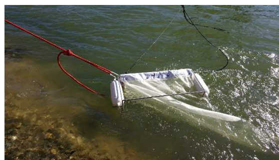
Illustration 19 : Filet manta en action lors d'un prélèvement en Garonne (Auteur : Florence Mouchet)
