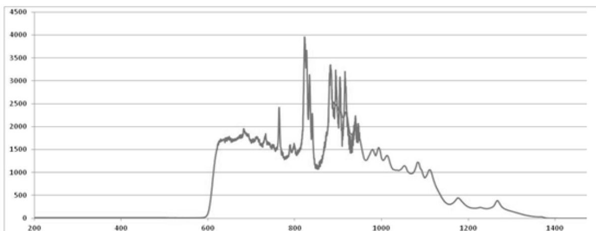
Figure 14 : Exemple de spectre d'émission d'un épilateur IPL.
