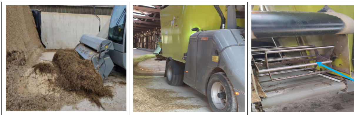
Figure 17 : Désileuse-mélangeuse-distributrice de la CUMA suivie.
