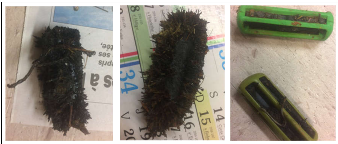
Figure 39 : De gauche vers la droite : aimant chargé de CE, aimant recouvert de limaille et aimants cages
