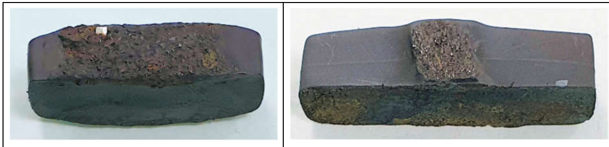
Figure 51 : Deux exemples d'aimants en gros plan présentant à la fois des signes de dissolution et de dépôts solides qui semblent soudés aux aimants (gangue).
