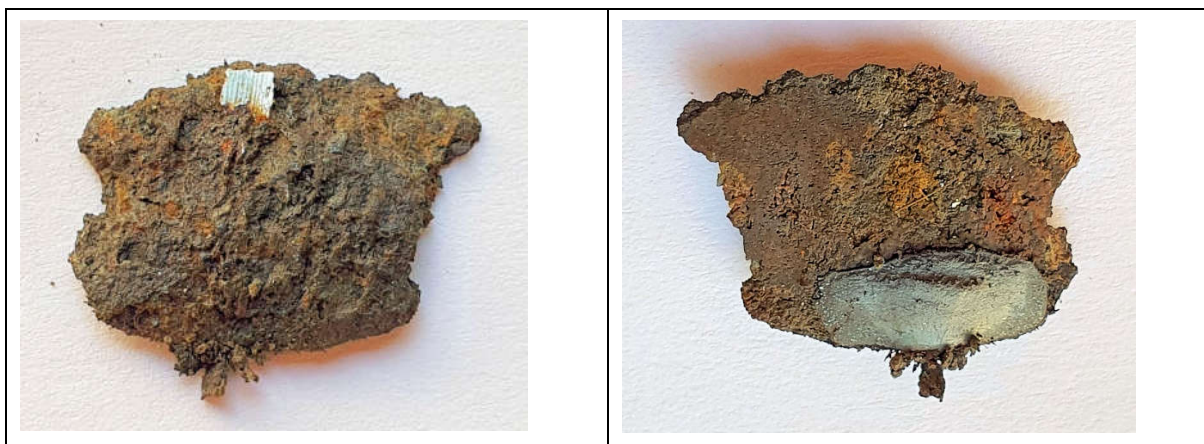
Figure 52 : Détails du morceau de gangue désolidarisé de l'aimant N°62 : à gauche la face externe, à droite la face interne.
