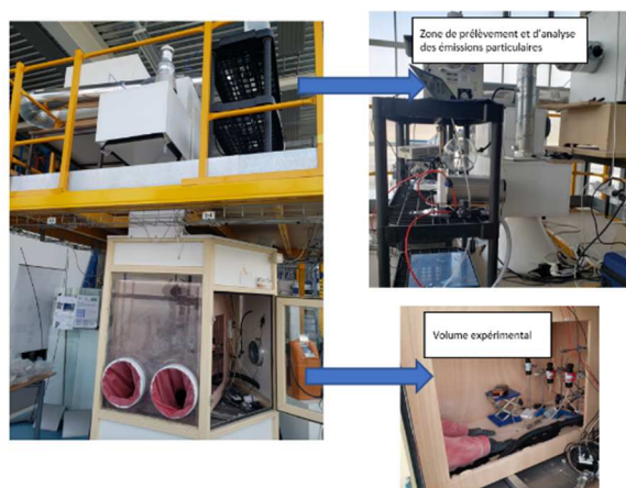
Illustration 16 : Banc d'essai Aerotest du CSTB (Crédits : CSTB)
